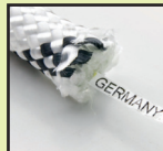
Tracer threads legible (EN 1891)
