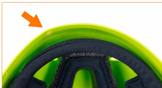
Yleinen kuoren muodonmuutos; materiaalissa näkyy merkkejä heikentymisestä.
