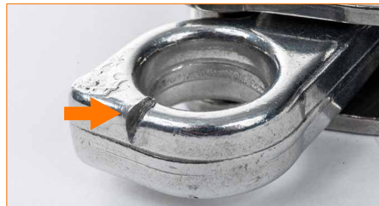
Lukitusvipu, jossa on selkeitä murtumien merkkejä.
