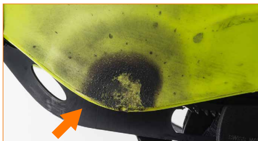
Kuori, jossa on palojälkiä.
