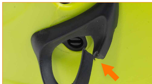
Rikkoutunut otsavalaisimen kiinnike.
