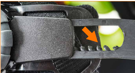
Pääpannan säätömekanismi, jonka hampaat ovat vaurioituneet ja joka ei pysy paikoillaan.
