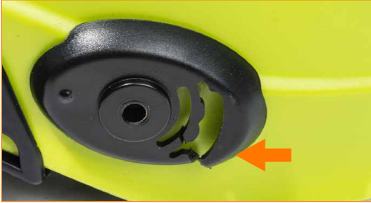
Rikkoutunut visiirin kiinnike. Vaihda sopivaan varaosaan.
