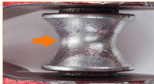
Erittäin kulunut väkipyörä, jonka syvennyksen muuttunut muoto on helposti havaittavissa.
