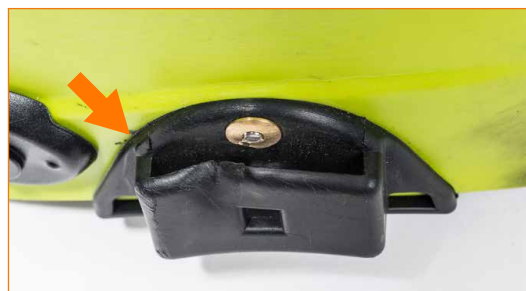
Kuulonsuojainten kiinnityspiste on käyttökelvoton. 🔧 Vaihda sopivaan varaosaan.
