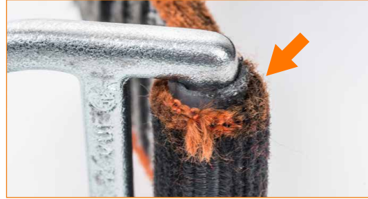
Nauhalenkki, joka on vaurioitunut kohdasta, jossa se on kosketuksissa metallirenkaan kanssa.
