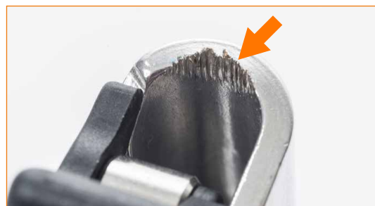
Laite joka on pysäyttänyt putoamisen: rungon reunassa on viiltoja, jotka johtuvat vaijerin liukumisesta.
