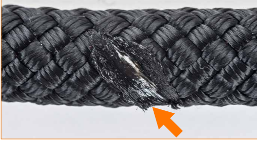
Köysi, jossa on selkeitä merkkejä kuumen esineen kanssa kosketuksissa olemisesta.
