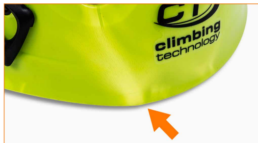
Yleinen kuoren muodonmuutos; materiaalissa näkyy merkkejä heikentymisestä.
