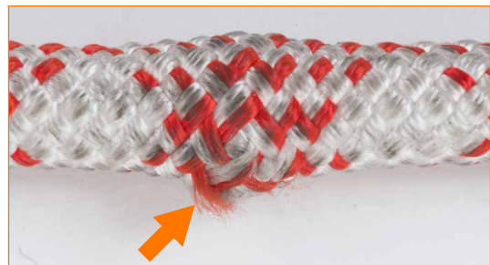
Sisäinen muhkura, ytimen turpoaminen havaittavissa.
