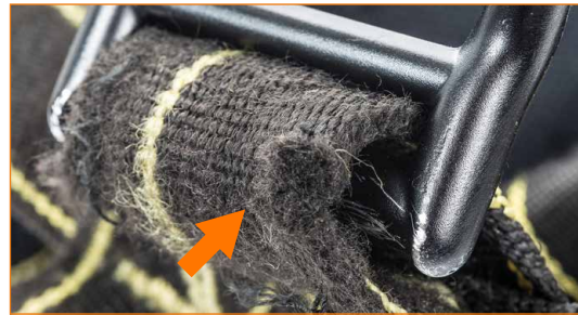
Hihna on erittäin kulunut rintakiinnityspisteen läheltä.
