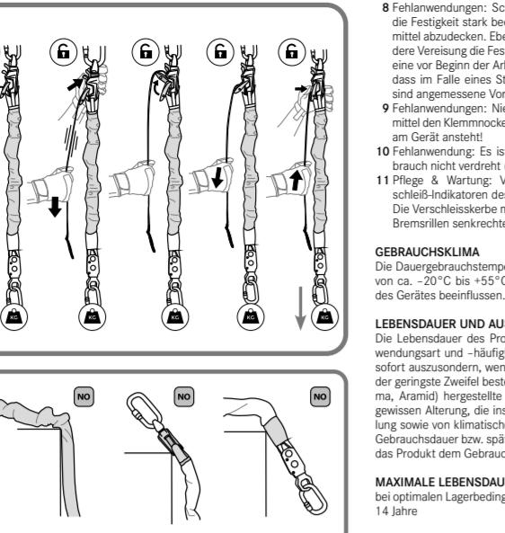
Fehlanwendungen: Scharfe Kanten, Grate und Abzweigungen können die Festigkeit stark schwächen, ggf. sind diese gegeignete Hilfslinien für die Sicherheit. Bei Verwendung von Edelrid Sicherheitsseilen wird die Festigkeit des Produktes stark beeinträchtigt.
